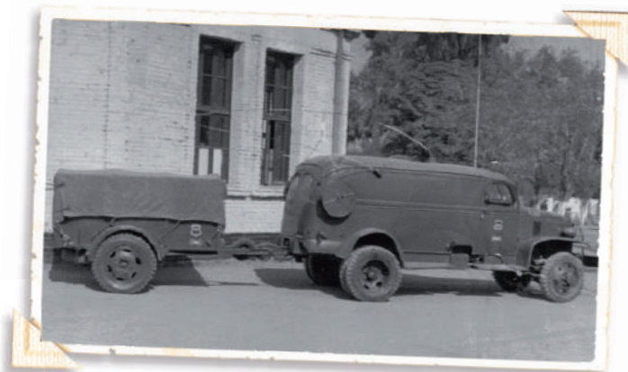
Estación vehicular de equipo de radio SCR-299, empleado en nuestro Ejército entre los años 1945 a 1968, como central a nivel de redes secundarias.
